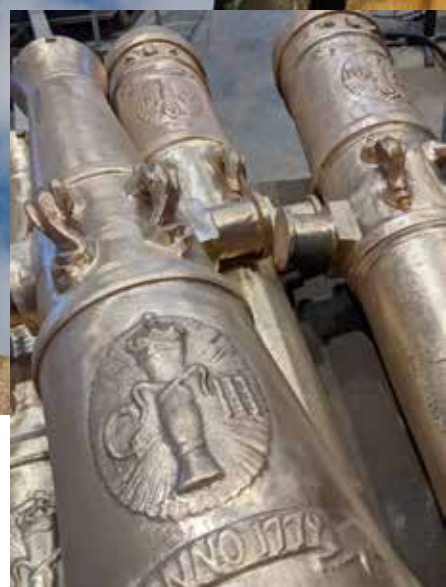
3D-scanning och print samt digital rekonstruktion av saknade bitar resulterar i "nya" gjutna kanoner avbildade av originalen från 1600-talet. Patinerade för att se gamla ut.
